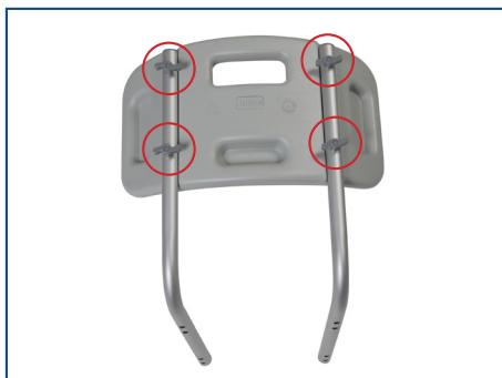
4. Fixez le dossier au siège en alignant les trous sur les supports du cadre en forme de « L » avec les trous sur les sections de patte. Fixez en place à l'aide de vis moletées les plus longues, en prenant note de « l'arrière » du siège inscrit sur le bas du siège.
