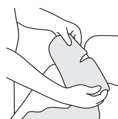
FIGURE 3.1 Enlèvement/Installation des barres supports métalliques dans l'élingue du modèle Standard
