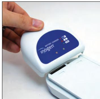
**VORSICHT** Vermeiden Sie es, die elektrischen Kontaktflächen des externen Batterieladegeräts zu berühren, da dies die Kontakte beschädigen und die Funktionsfähigkeit des Ladegeräts beeinträchtigen kann.
