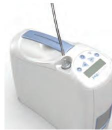
**PRECAUCIÓN** Con objeto de garantizar el flujo de oxígeno, verifique que la cánula nasal esté debidamente acoplada a la boquilla de ajuste y que no se encuentre doblada ni pinzada.
