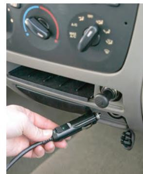
3. Der Stecker sollte sich ohne besonderen Kraftaufwand in die Buchse einstecken lassen und gut sitzen. Der Zigarettenanzünder-Adapter ist mit einem Schiebeschalter ausgestattet, der auf die „enge“ Position voreingestellt ist. Diese Einstellung sollte in die meisten Kfz-Zigarettenanzünder passen. Falls der Zigarettenanzünder-Adapter locker in der Buchse sitzt, den Schalter in die „breite“ Position schieben.
