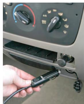
3. La fiche doit s'insérer dans la prise sans trop forcer et rester bien en place. L'adaptateur d'allume-cigares comporte un interrupteur à glissière préréglé sur la position étroite. Il s'adapte ainsi à la plupart des prises d'allume-cigares d'automobile. S'il y a du jeu entre l'adaptateur d'allume-cigares et la prise, réglez l'interrupteur à glissière sur la position « large ».
