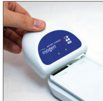
**PRECAUCIÓN** Evite el tocar los contactos eléctricos del cargador de batería externa, pues el daño de los contactos puede afectar la operación de carga.
