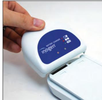
**ATTENZIONE** Evitare di toccare i contatti elettrici incassati nel caricabatteria esterno. Se i contatti vengono danneggiati il funzionamento del caricabatteria può risultare compromesso.
